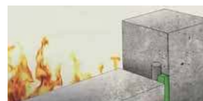
C Sellado simple con acrílico FP 401
