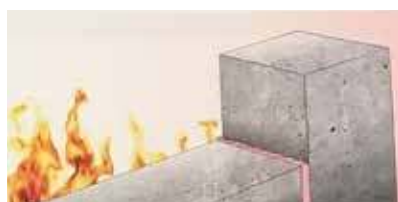
Junta sellada con espuma FP 404
